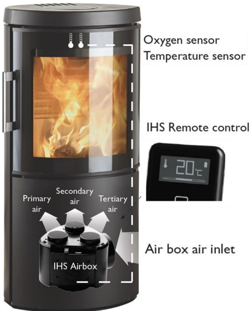
Figuur 5.12 Een kachel van fabrikant HWAM waarbij de invloed van de gebruiker is beperkt door computergestuurde luchttoevoer op basis van sensoren in het rookgas voor zuurstofconcentratie en temperatuur [43].
