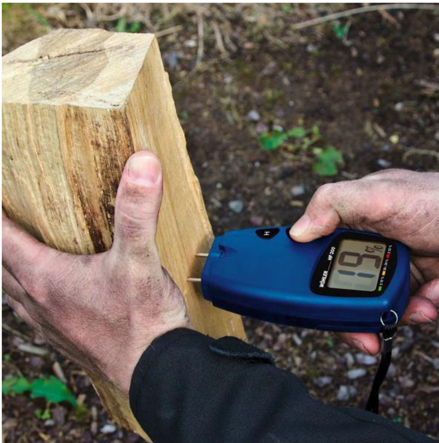
Figuur 5.8 Bepalen van het vochtgehalte met een eenvoudige vochtmeter.
