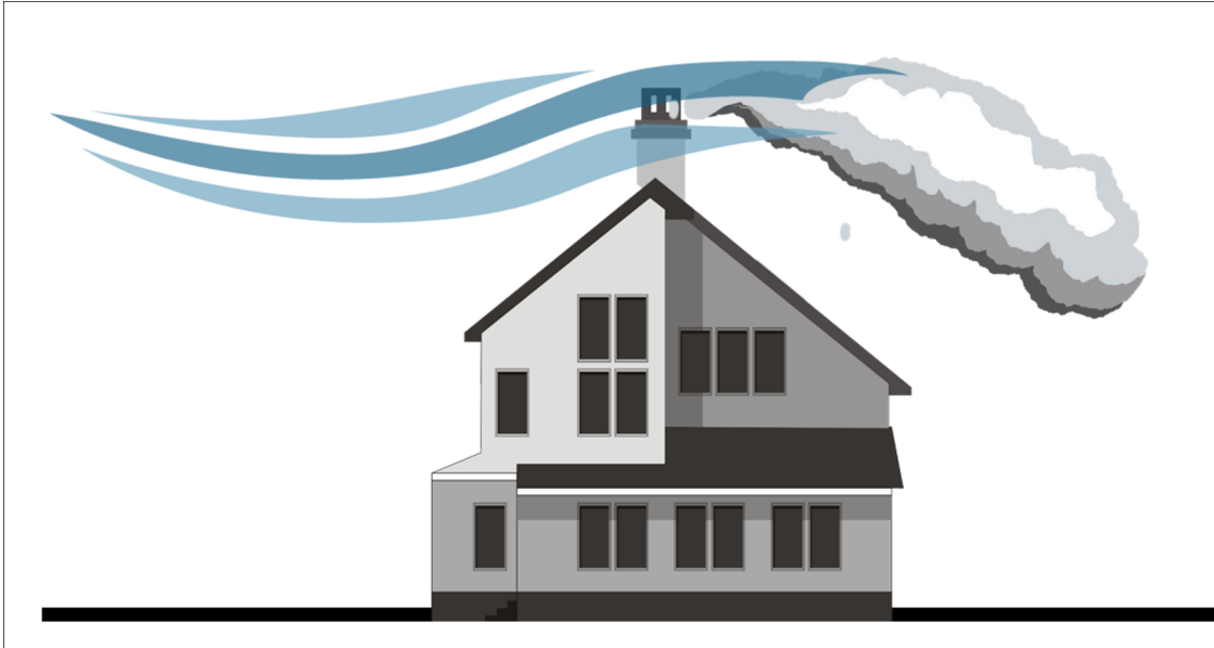
Afbeelding 8.13: Downwash effect bij rookgasafvoer boven nokhoogte.
