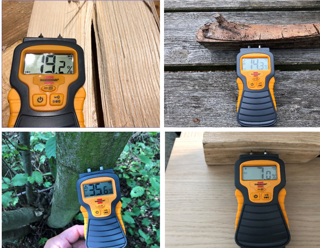
Afbeelding 3.2: Houtvochtmeter met op de display het watergehalte op volumebasis. Linksboven haardhout dat een dag eerder bij een bouwmarkt is gekocht. Rechtsboven essenhout dat drie jaar in de buitenlucht heeft gedroogd. Linksonder levend beukenhout dat maximaal vocht bevat en rechtsonder extreem droog haardhout dat na de normale droogtijd nog eens circa één jaar binnenshuis is gedroogd.
