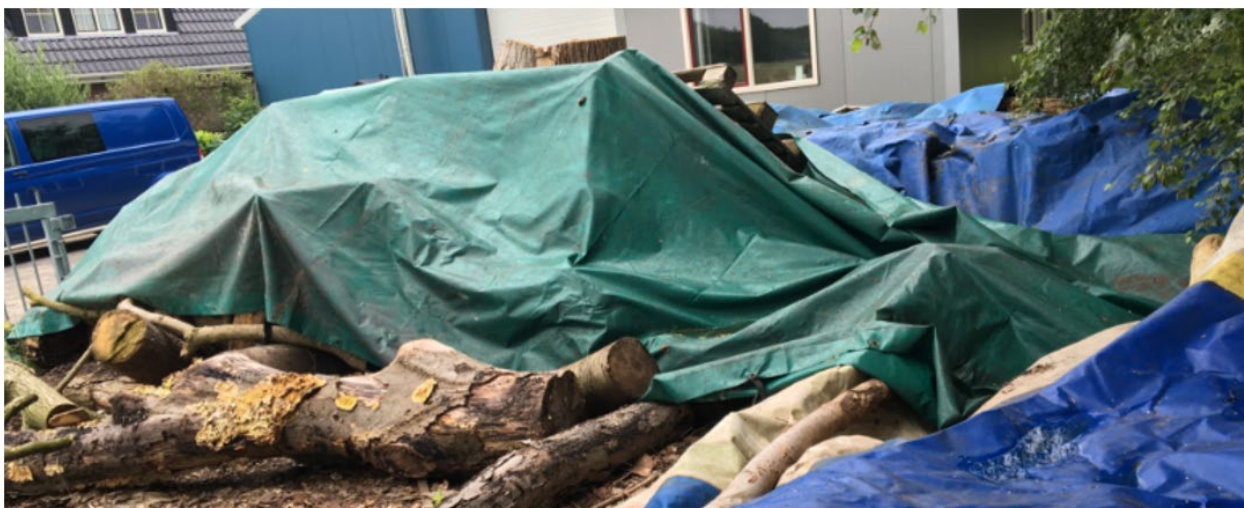
Afbeelding 3.4: Voorbeeld van slechte vochttafvoer door afdekking met zeil.
