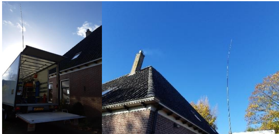
Figuur 2: Meetwagen met snuivermast: afstand ca 10 meter tot de schoorsteenmonding. Voorzijde (foto rechts) en achterzijde (foto links) van de gemeten schoorsteen. De houtrookpluim is zichtbaar op beide foto's.
